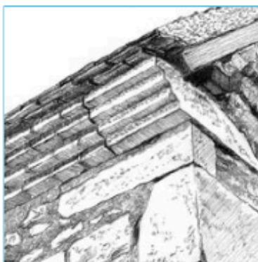
Détail de corniche en brique
